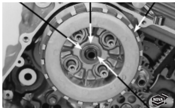
ARRUELA CÔNICA FIXADOR DO CUBO DA EMBREAGEM PORCA-TRAVA
