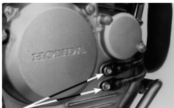
PARAFUSOS/TUBOS DE ÓLEO/ANÉIS DE VEDAÇÃO
