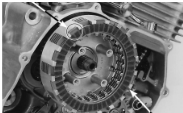
DISCO DE EMBREAGEM EXTERNO MARCA "OUT SIDE" CUBO DA EMBREAGEM
