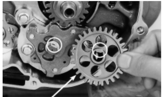
ENGRENAGEM MOVIDA DA BOMBA DE ÓLEO
