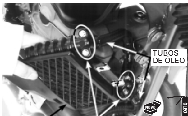
RADIADOR DE ÓLEO PARAFUSOS/ANÉIS DE VEDAÇÃO
